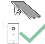
Memastikan kabel terpasang secara alami tanpa tegangan
