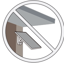
Hindari naungan dari atap bangunan
